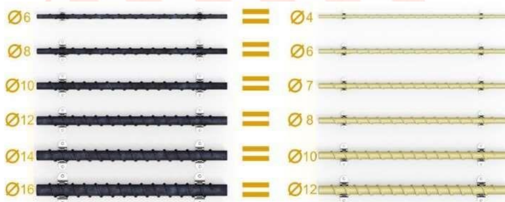
Рис. 4. Разница диаметров композитной и металлической арматуры.
