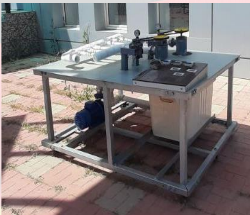
2-расм. Пико гидротурбина моделларини тажриба-синовдан ўтказиш учун тайёрланган стенд фотосурати.
